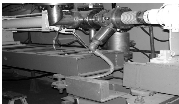
Рис.4. Датчик положения и тока пучка (вверху) и блок 5-канального усилителя-корректора (внизу) в бункере ускорителя ЛУЭ-40М
