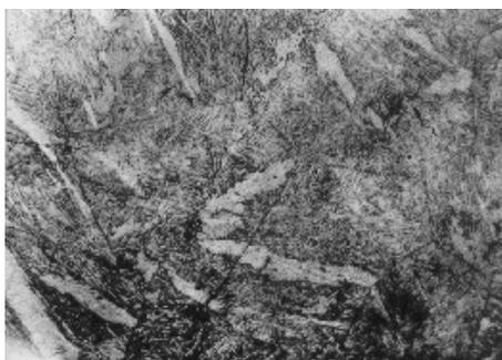
Рис. 3. Микроструктура материала сварных швов на изделиях из сплава Zr1Nb, полученных электронно-лучевой сваркой, ув. 200
