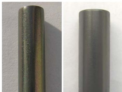
Рис. 2. Типичный внешний вид образцов гафния ГФЭ-1 после испытаний на протяжении 14000 ч при температуре 350 °С и давлении 16,5 МПа
