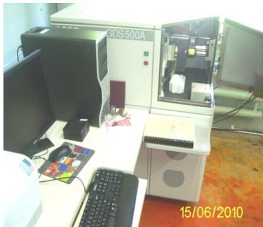
Рис. 4. Оптический эмиссионный электронный спектрометр GDS 500
