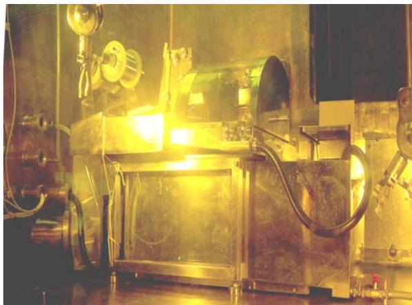
Рис. 3. Электроэрозионный станок, установленный внутри «горячей» камеры
