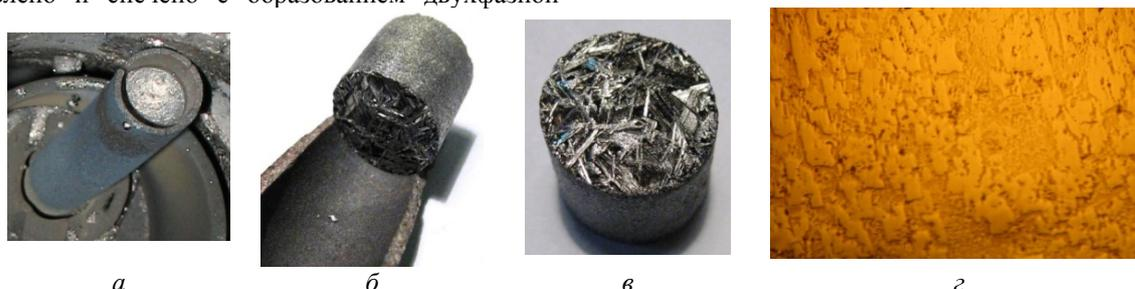
Рис. 4. Макеты пэлов при выдержке при температуре 1600 °С в течение 10 мин: а - оболочка канала с макетом пэла в тигле; б - макет пэла в разрезанной канальной трубе; в - содержание макета пэла; г - структура материала макета пэла
