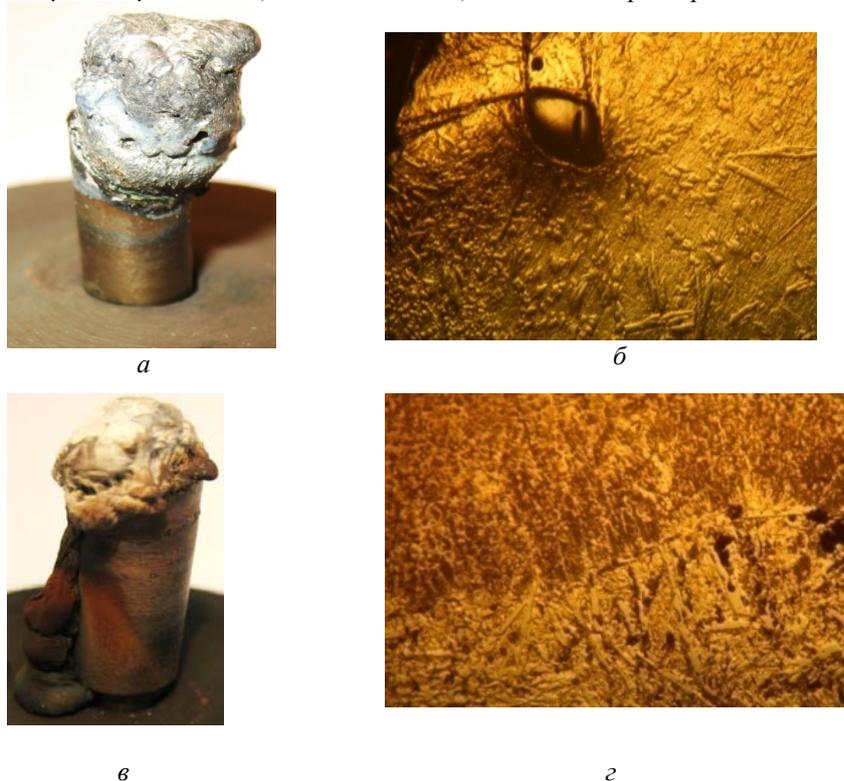
Рис. 6. Макеты пэлов при расплавлении электрической дугой: а - расплав макета пэла после эксперимента; б - структура расплавленной зоны макета пэла; в - расплав макета пэла в твэльной оболочке; г - структура расплавленной зоны макета пэла в месте сплавления с оболочкой твэла
