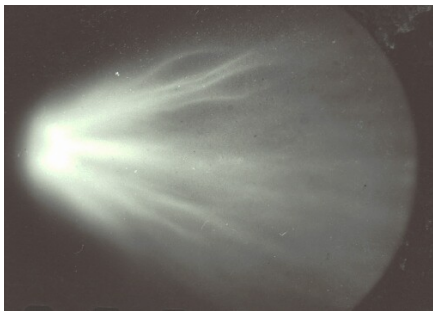
Рис.4. Изображение тлеющего высоковольтного разряда при атмосферном давлении
