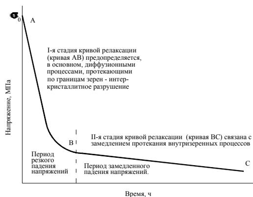
Рис.2. Схема кривой релаксации напряжений
