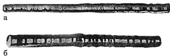
Рис.9. Монокристаллы вольфрама диаметром 10 мм (а) и молибдена диаметром 16 мм (б), полученные бестигельной зонной плавкой электронным пучком
