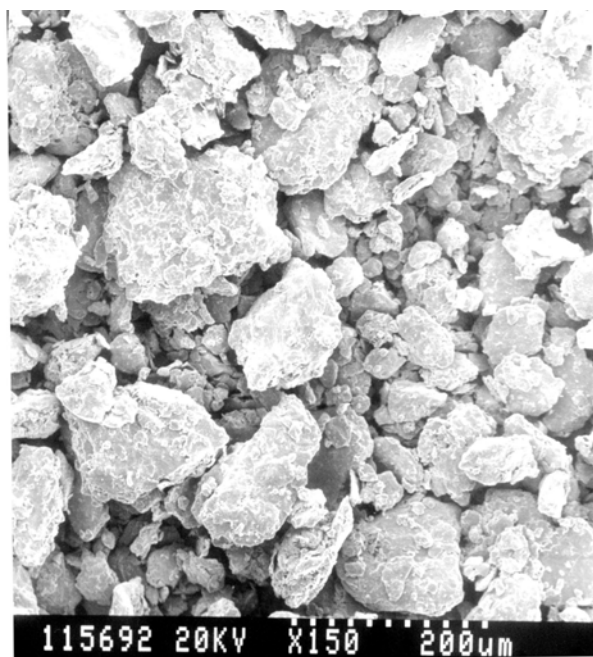
Рис. 3. Порошок стали ЭП-450 после 49 ч механического легирования
