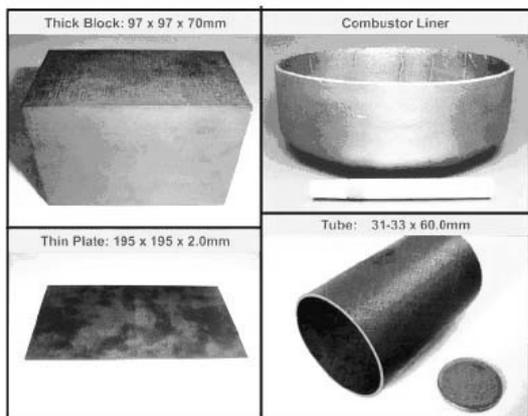
Рис. 4. Различные формы композита SiC/SiC, полученного по методу NITE [2]
