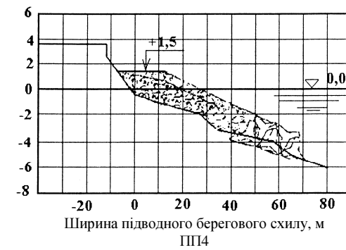
Рис. 4. Штучний щебеневий пляж в поєднанні з кам'яно-накидною бермою і упором із залізобетонних блоків.
