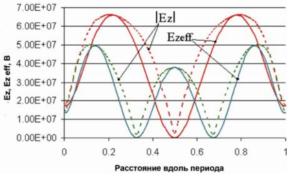
Рис.5. Распределения амплитуды |E_z| и эффективного ускоряющего поля E_{zeff} на оси структуры по длине периода для второй ( \theta=320^\circ ) и третьей ( \theta=510^\circ ) полос пропускания
