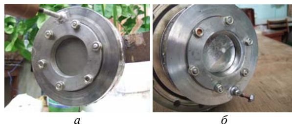
Рис.6. Состояние поверхности конвертера с охлаждением (W): а – после нагрева в пламени газовой горелки; б – после импульсного однократного облучения сильноточным РЭП
