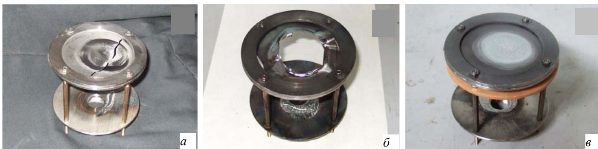
Рис.4. Состояние мишеней после облучения сильноточным РЭП ускорителя ТЕМП-А (микросекундный ствол): а – мишень из W ( \delta = 200 мкм, 2 выстрела); б – мишень из Ta ( \delta = 50 мкм, 3 выстрела); в – мишень из Mo ( \delta = 500 мкм, 15 выстрелов)
