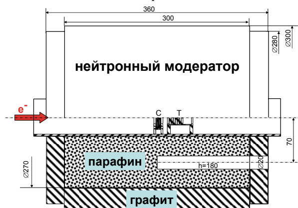
Рис.2. Мишенное устройство с замедлителем нейтронов
