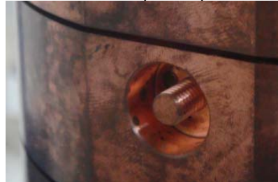
Рис.14. Конструкция для подстройки частоты ячеек
