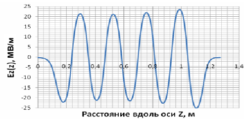
Рис.11. График зависимости продольной составляющей электрического поля от продольной координаты
