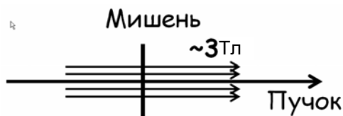
Рис. 2. Схема поляризации ферромагнитной фольги методом «грубой силы»
