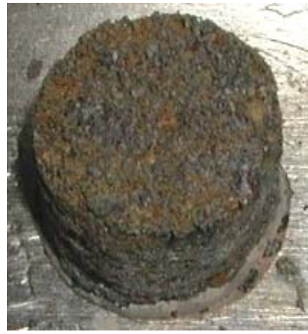
Рис. 6. Образец состава №6 ( T_{отж} ~ 1400 °С, 1 ч, вакуум)
