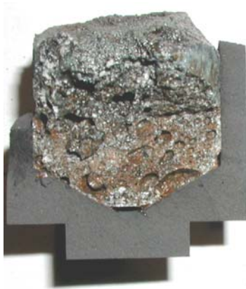
Рис. 14. Образец состава № 14 ( T_{отж} ~ 1550 °С, 5 мин, воздух)
