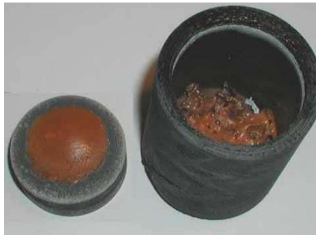
Рис. 8. Образец состава №6 ( T_{отж} ~ 1500 °С, 1 ч, вакуум)
