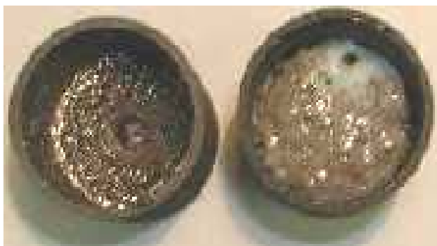
Рис. 1. Результат взаимодействия ZrO_2+UO_2 с песком
