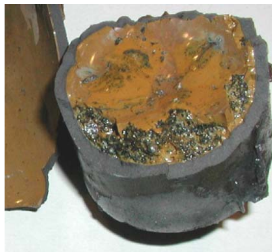
Рис. 13. Образец состава №12 ( T_{отж} \sim 1500^\circ\text{C} , 5 мин, воздух)
