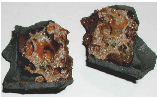
Рис. 18. Образец состава № 12 (шихта содержит 9,66 мас.% UO_2 , воздух)
