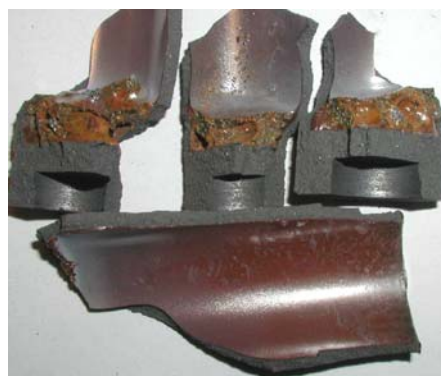
Рис. 19. Образец состава № 13 (шихта содержит 16,8 мас.% UO_2 , воздух)
