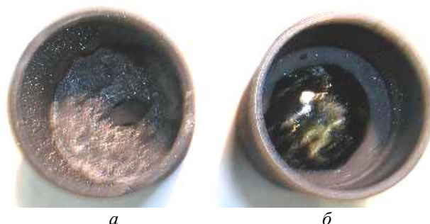
Рис. 2. Результат взаимодействия ZrO_2+UO_2 с измельченным бетоном
