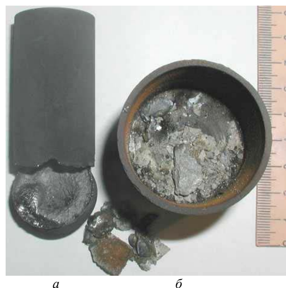
Рис. 4. Результат взаимодействия ZrO_2+UO_2 с серпентинитом
