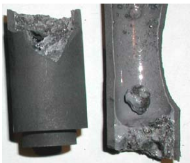
Рис. 16. Образец состава № 18 (шихта без UO_2 , воздух)
