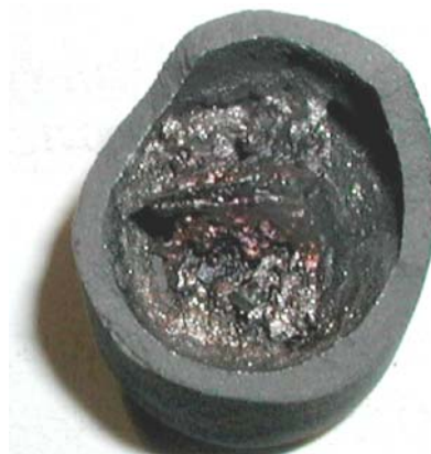
Рис. 15. Образец состава № 12 ( T_{отж} ~ 1750 °С, 5 мин, воздух)
