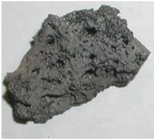
Рис. 5. Образец состава №6 ( T_{отж} ~ 1900 °С, 1 ч, вакуум)
