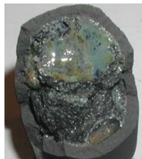
Рис. 17. Образец состава № 17 (шихта содержит 4,98 мас.% UO_2 , воздух)
