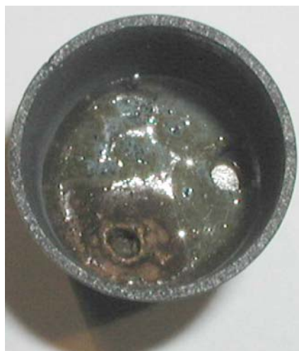
Рис. 12. Образец состава №12 ( T_{отж} \sim 1500^\circ\text{C} , 5 мин, воздух)
