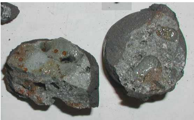
Рис. 9. Образец состава №3 ( T_{отж} ~ 1450 °С, 20 мин, вакуум)
