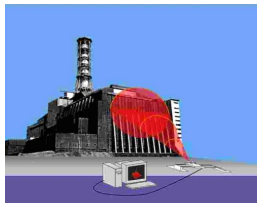
Рис. 10. Схематическое изображение дистанционного мониторинга саркофага Чернобыльской АЭС с помощью наземного шумового РСА
