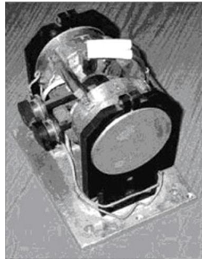
Рис. 1. Генератор хаоса на основе слабрезонансной ЛОВО 8-мм диапазона
