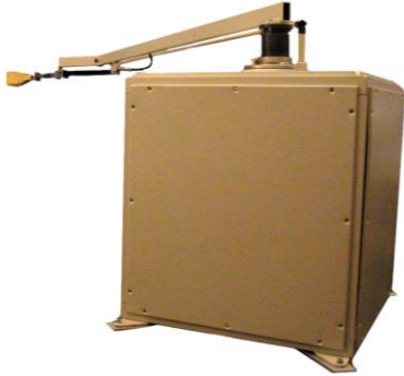
Рис. 8. Внешний РСА на базе когерентно-импульсного шумового радара кругового обзора
