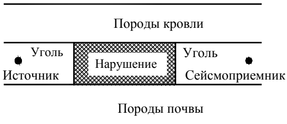
Рис. 1. Обобщенная модель нарушения угольного пласта
