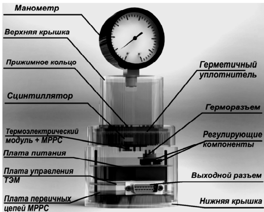
Рис. 8. Вид конструкции компактного настольного стенда для исследования режимов работы малогабаритных органических сцинтилляционных детекторов
