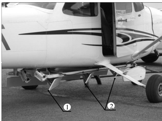
Рис. 2. Антенны РСА, смонтированные на легком самолете «Цессна-172»: 1 – передающая антенна; 2 – приемные антенны
