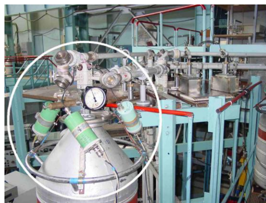
Рис. 2. Внешний вид четырёхканального низкотемпературного приёмника (отмечен окружностью) в составе многоканального интерферометра ( \lambda = 337 мкм)
