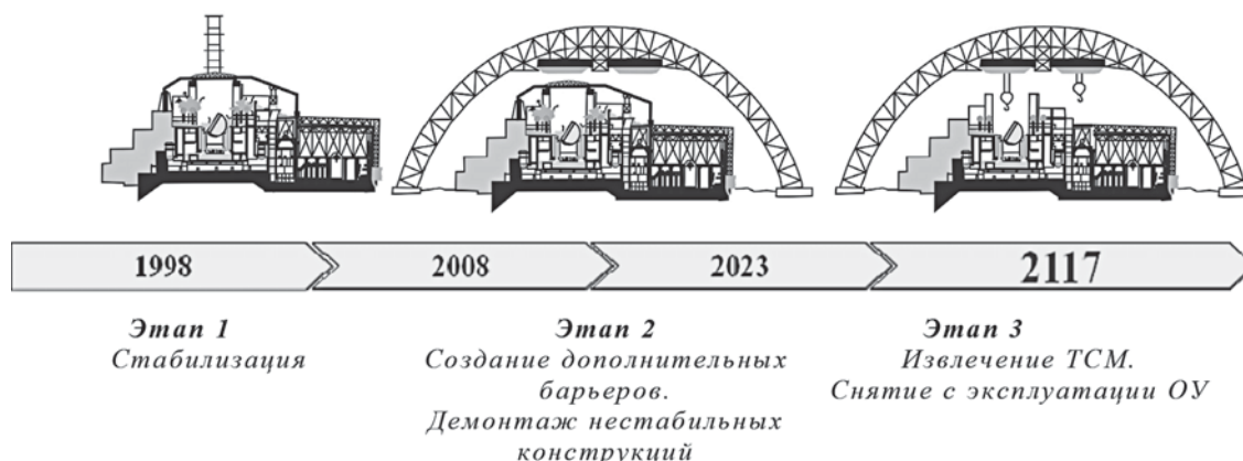
Рис. 5. Преобразование объекта «Укрытие» в ЭБС
