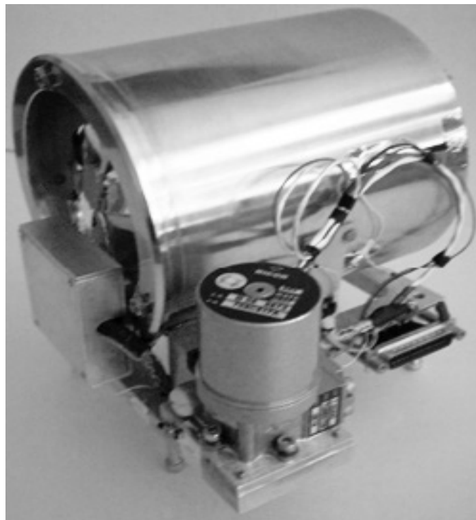
Рис. 2. Миниатюрный ОЧГ гамма-спектрометр для космических применений
