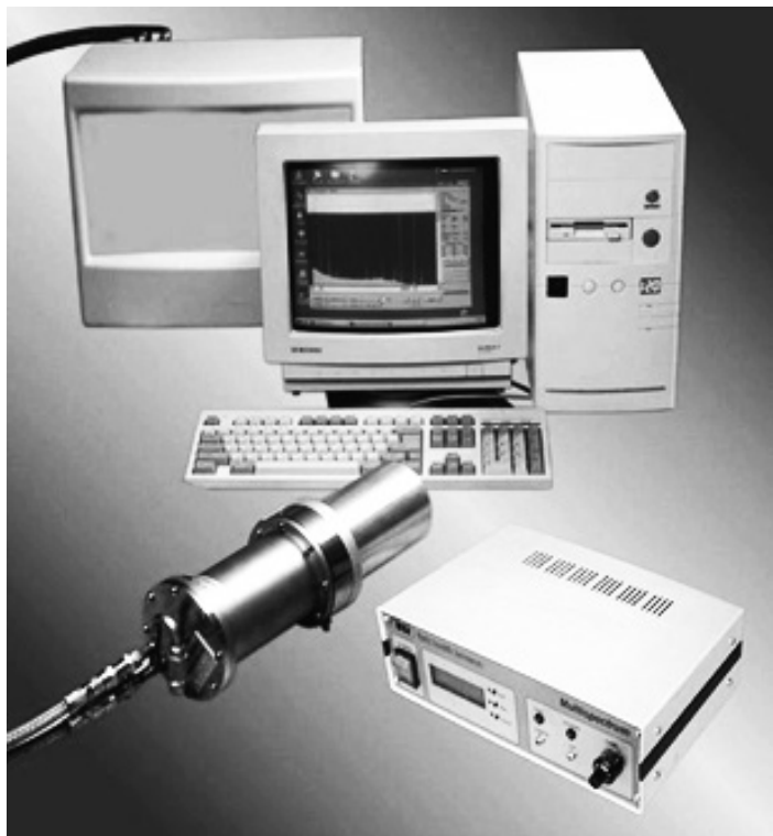
Рис. 1. ОЧГ-спектрометр на базе электроохладителя Джоуля—Томсона
