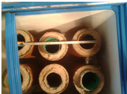
Рис. 2. Омоноличивание КГЭ фильтров в морозильном ларе
