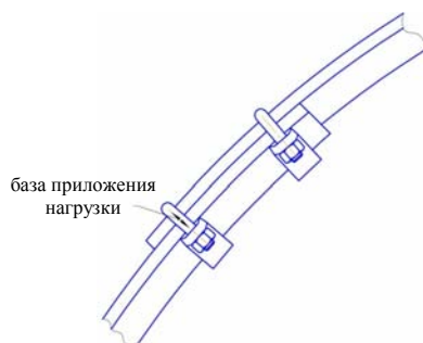
Рис. 7. Схема установки замков ЗПКм в узле податливости
