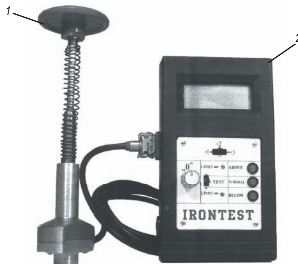
Рис. 1. Прибор для неразрушающего контроля структуры сталей и чугунов: 1 – намагничивающее устройство; 2 – электронный блок
