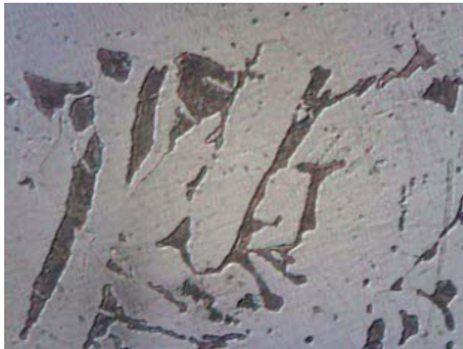
Рис. 5. Микроструктура зони сплавлення при наплавке стали 45 на сталь 45, \times 200
