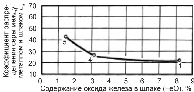
Рис. 3. Влияние содержания \text{FeO} в шлаке на фактический коэффициент распределения серы между металлом и шлаком при внепечной обработке металла твердой шлакообразующей смесью (ТШС) и силикокальцием ( \text{SiCa} ). Удельный расход смеси – 9 кг/т стали, силикокальция – 1,6 кг/т: 1, 4, 5 – количество плавов
