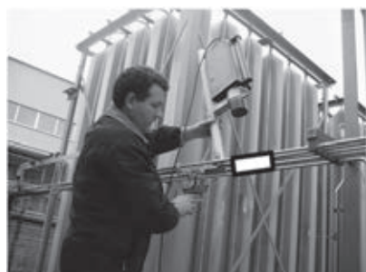
Флэш-радиография четырехниточного трубопровода на кислородном заводе
