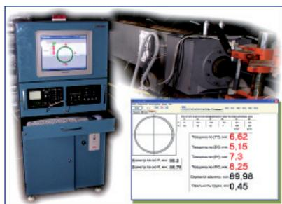
С целью обеспечения высоких эксплуатационных и технических характеристик установка осуществляет автоматическую компенсацию влияния температуры охлаждающей среды (воды) и материала трубы на результаты измерений.
