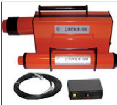
Предназначены для радиографии в нестационарных условиях, при контроле конструкций в труднодоступных местах, контроле швов трубопроводов. Рабочие комплекты аппаратов укладываются в носимые чемоданы-укладки.
