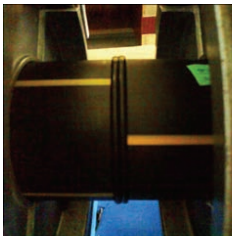
Рис. 1. Внешний вид стыкового соединения
