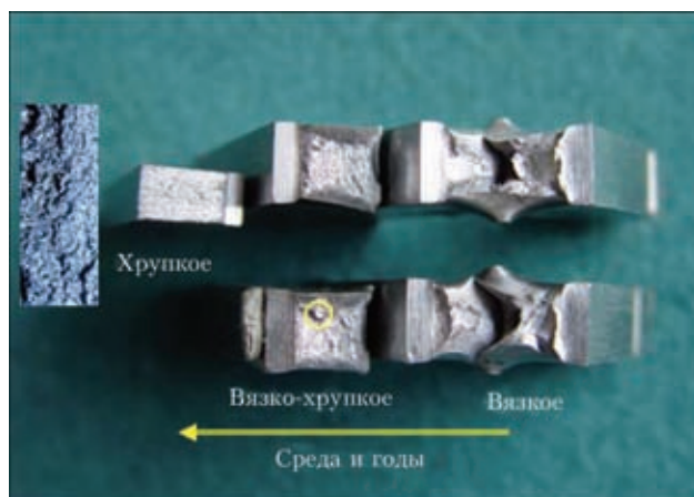
Рис. 2. Образцы после испытаний на ударную вязкость в зависимости от времени наработки (стрелка — деградация материала с течением времени)
