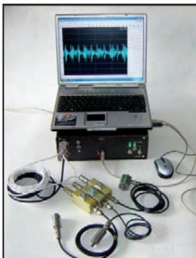
за детерминированной и случайной составляющих вибрационного сигнала; использует методы статистического оценивания вероятностных характеристик вибрационных сигналов на основе теории периодически нестационарных процессов, что позволяет определять глубину модуляций, присутствующих в сигнале, и оценивать остаточный ресурс механизмов продолжительной эксплуатации.
