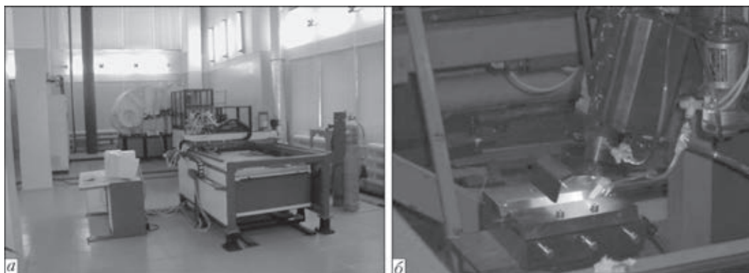
Рис. 3. Внешний вид АЛТК «Сибирь 1» (а) и лабораторного стенда (б) для лазерной сварки
