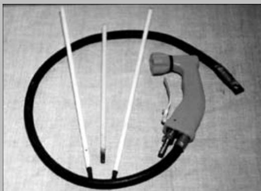
Применяются для электрокислородной резки под водой металлоконструкций из конструкционных сталей толщиной до 40 мм на глубине до 60 м. Обеспечивают производительность не менее 300...350 мм реза одним электродом листовой стали толщиной 14 мм. Время горения одного электрода  $\approx 1,5$  мин, масса электрода  $\approx 180$  г. Расход кислорода —  $0,20...0,25$  м<sup>3</sup>/пог. м.
