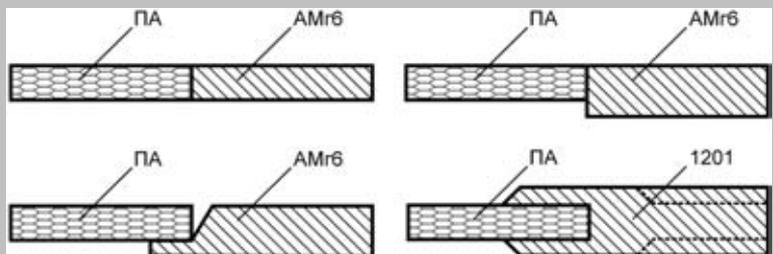
*Результаты экспериментов показали, что соединение заготовок из ПА между собой с использованием сварки плавлением не представляется возможным. Разработана технология соединения ПА через вставки из серийных алюминиевых сплавов. Аналогичная схема соединения может применяться и в других сварных конструкциях, где используются заготовки, полученные как по традиционной технологии, так и из ПА.*
