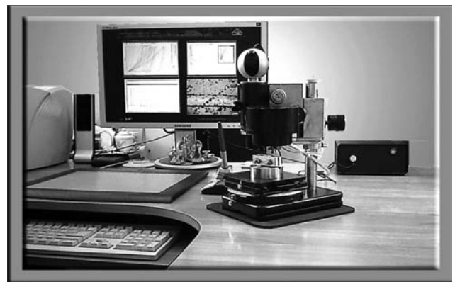
Рис. 4. Компьютеризированная микронзондовая система «Микрон-Гамма» для микромеханических испытаний при нагрузках от 5 до 500 г
