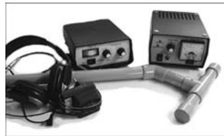
видами дорожніх покриттів, без розкриття ґрунту, для визначення безконтактним способом місця розташування і глибини залягання трубопроводу. За призначенням і експлуатацією ПКІ-1 аналогічний АНПІ-А, проте має вищу завадозахищеність і селективність.
