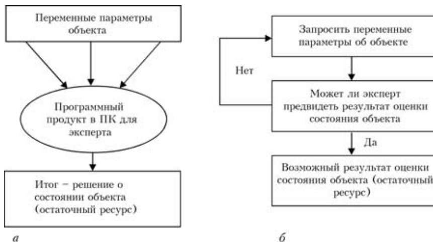
Рис. 8. Решения задач экспертной системой: а — параллельные процедуры получения информации об объекте с последующей выработкой решений; б — последовательное получение информации и принятие решений
