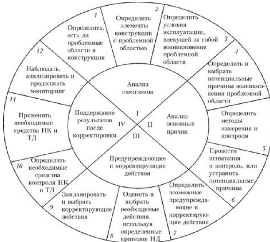
Рис. 2. Модель корректирующих и предупреждающих действий для решения проблем в сварных конструкциях
