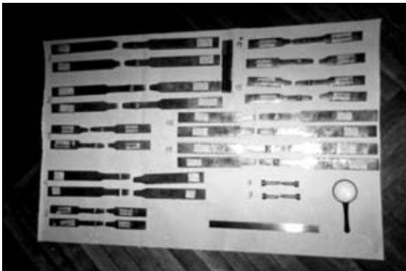
Рис. 3. Образцы сварных соединений, полученные при механических испытаниях и применяемые для корректирующих действий при ремонте
