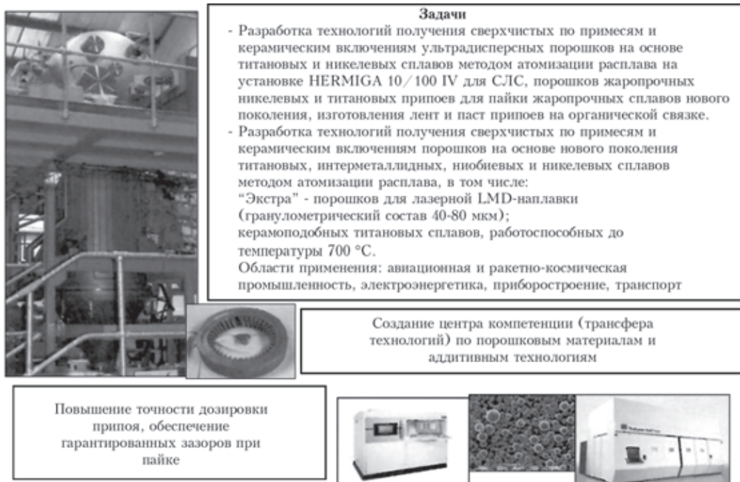
Рис. 5. Развитие технологий атомизации для получения мелкодисперсных высококачественных металлических порошков
