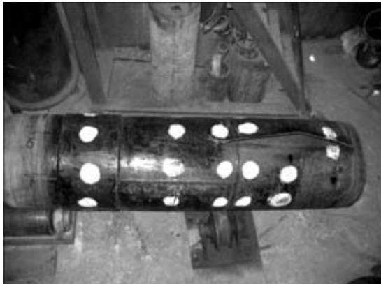
Рис. 7. Натурный образец D325 после испытания до разрушения внутренним давлением
