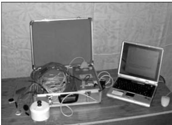
используемых при ремонтно-восстановительных работах, и установления соответствия их действительных значений рекламируемым необходима аппаратура для измерения теплопотерь и термического сопротивления. Для решения этой задачи учеными Института технической теплофизики НАН Украины создан универсальный измерительный комплекс «Ресурс». Эта разработка базируется на 50-летнем опыте по созданию приборов для прямых измерений плотности теплового потока, температуры и теплофизических свойств.
