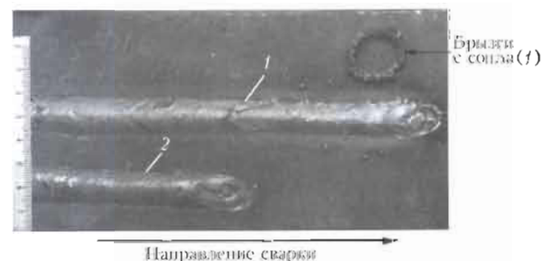
Рис. 1. Внешний вид металла швов при ИДСПЭ стали Ст3сп проволокой Св-08Г2С диаметром 1,6 мм в смеси газов 82 % Ar + 18 % CO 2 (скорость сварки 16 м/ч, длительность импульса 3,4 мс): 1 — U_c = 376...380 В (первая половина шва), 342...354 В (вторая); K_p = 6,5...7\% ; 2 — U_c = 376...380 В; I_{cp} = 250 А; U_{cp} = 25 В; частота импульсов 82 Гц; K_p = 1...1,5\%
