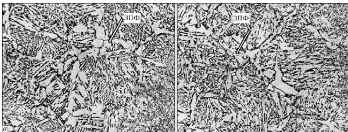
Рис. 4. Микроструктура ( \times 400 ) металла образцов имитируемой ЗТВ с замедленной скоростью охлаждения ( t_{8/5} = 100 с, V_{\text{охл.8/5}} = 3 °C/c): a — образец В; б — Б (ЗПФ — зернограничный полигональный феррит)
