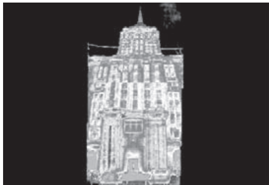
Рис. 8. Регистрация температурного поля с поверхности контролируемого объекта
