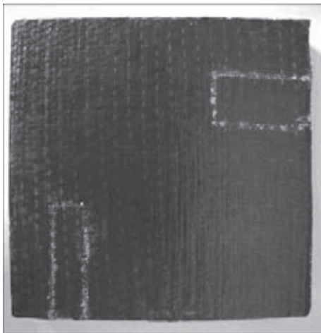
Рис. 3. Исследуемая пластина с обозначенными местами расположения дефектов
