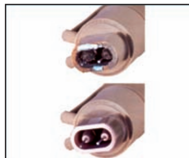
Рис. 2. Автоматизированная тандемная горелка до и после очистки
