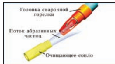
Рис. 1. Принцип очистки головки горелки с вращающейся очистительной насадкой
