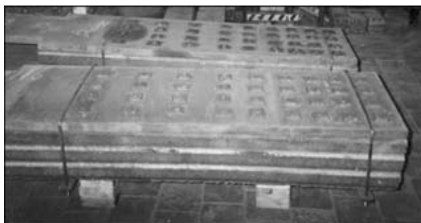
Рис. 7. Фрагменты двух контактных сборок для подины алюминиевого электролизера
