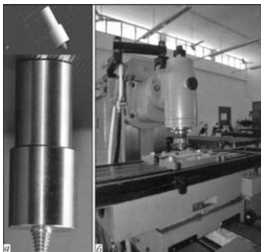
Сварочный инструмент из быстрорежущей стали (а) и внешний вид фрезерного станка с ним (б)
